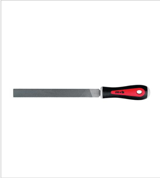
Grande longévité de la coupe grâce à l'acier fortement chargé en carbone (1,3 à 1,4 %) acier allié au chrome pour obtenir un mordant puissant dureté de 65 à 12 HRC manche bi-matière : polypropylène (résistance et relief permettant de travailler avec précision) et élastomère (souple et confortable - limite la transpiration et l'échauffement de la main).
