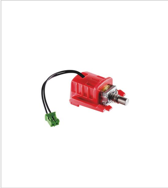
Aimant de verrouillage qui bloque mécaniquement le moteur dans n'importe quelle position jusqu'à une force d'attaque de 300 kg
