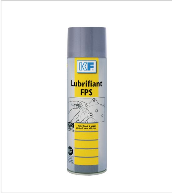
Lubrifiant polyvalent, incolore et inodore sans silicone utilisation recommandée en industrie alimentaire lorsqu'un contact accidentel avec les aliments est possible protège contre la rouille et la corrosion réduit les frottements et l'usure excellent pouvoir de pénétration utilisable de - 18°C à + 120°C (150°C en pointe).
