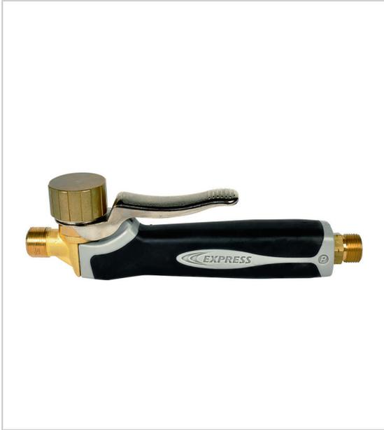
Manche à gâchette "bimatière" à raccord tournant filetage entrée 3/8" gauche, double étanchéité du raccordement aux lances (joint nitrile et cône métal sur métal) filetage raccordement lance M18 x 1 mâle.
