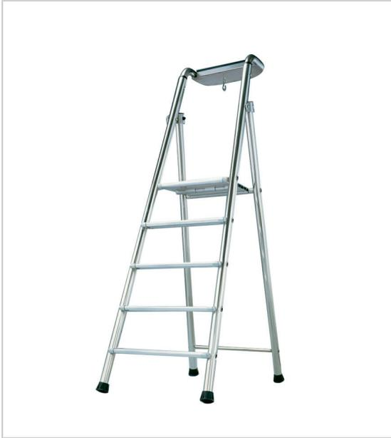
Structure tubulaire Ø 50 mm pour usage intensif en conditions extrêmes dans le BTP (testé à 350 Kg) éléments de sécurité et de confort sur-dimensionnés garde-corps anti-basculement avant de 700 mm de hauteur large repose-pieds 390 x 380 mm en aluminium nervuré extrudé anti-dérapant larges marches striées antidérapantes de 100 mm charge maximum d'utilisation : 150 Kg porte-outils et porte seau intégrés garantie 5 ans.
