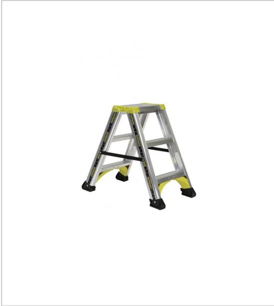
Larges et solides profils aluminium au design ergonomique 2 sangles de sécurité anti-écartement (2x3 et 2x4 marches) compas anti-écartement (2x5 marches) articulations anti pince-doigts marches antidérapantes de 80 mm soudées sur de larges profils aluminium patins extra larges antidérapants.
