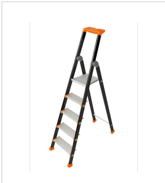
Marches serties antidérapantes de largeur 110 mm en aluminium extrudé articulations monobloc en fonderie d'aluminium, nervurées, ultra-résistantes porte-outils avec fermeture intégrée plate-forme large de 280 x 250 mm sabots enveloppants antidérapants avec témoin d'usure montants en peinture époxy 2 sangles noires pour les modèles 7 et 8 marches.
