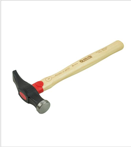
Tête rondeutilisé au départ par les chaudronniers, pour donner une forme aux tôlestête en acier à forte teneur en carbone C45E. Tête forgée, avec traitement thermique par induction des surfaces travaillantes (54 HRC)parties travaillantes poliespeinture poudre époxydique par procédé électrostatique, suivi d'une cuisson au four.manche Hickory : bois dur de densité élevée, adapté aux usages intenses ou fréquents.
