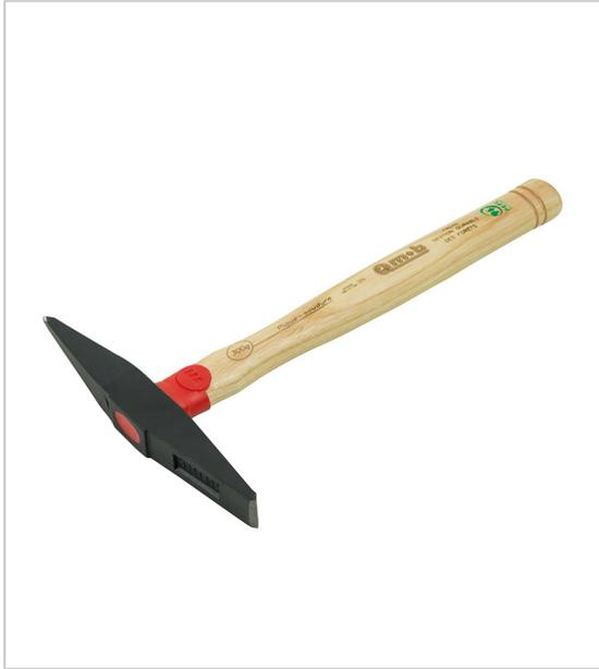
Tête en acier à forte teneur en carbone C45E tête forgée, avec traitement thermique par induction des surfaces travaillantes (54 HRC) parties travaillantes polies peinture poudre époxydique par procédé électrostatique, suivi d'une cuisson au four manche en frêne européen : comportement mécanique souple, contribuant notamment au fouet et à l'absorption des vibrations emmanchement réalisé par une machine hydraulique.
