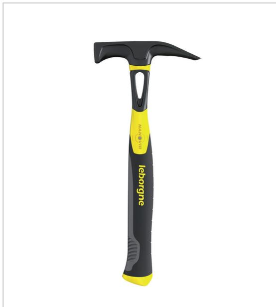
Prévention de la pénibilité : 50 % de vibrations en moins grâce au système breveté NANOVI B manche en acier trempé, emmanchement par sertissage poignée tri-matière ergonomique anti-glissement partie inférieure du manche évasée aimant porte-clou arêtes supérieures vives : racler les résidus de béton extrémité du manche en polymère dur : ajuster les matériaux sans les abîmer.
