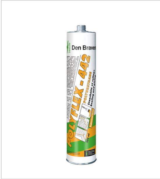
Mastic colle polyuréthane moyen module pour joints d'étanchéité et de dilatation dans le bâtiment pour joints de raccordement entre menuiseries et maçonnerie très bonne adhérence sur la plupart des supports du bâtiment résistant à l'eau, à l'eau salée, aux graisses, aux détergents ménagers usuels, au vieillissement et aux variations climatiques résistance à la température : -30°C à +70°C température d'application : +5°C à +40°C.
