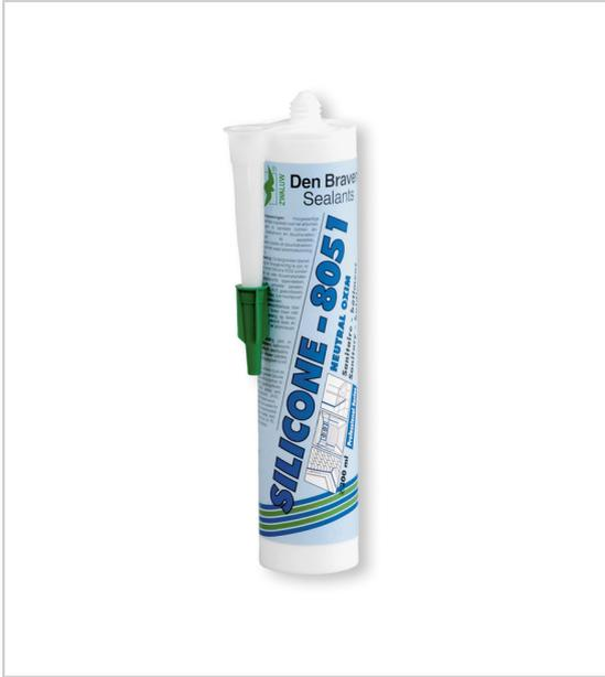
Mastic silicone neutre oxyme pour des applications bâtiment et sanitaire compatibilité alimentaire (lanesco) faible odeur excellente adhérence sans primaire sur la plupart des supports du bâtiment, naturels ou synthétiques résistant aux moisissures excellente résistance au vieillissement climatique et aux UV résistance à la température : -40°C à +120°C température d'application : +5°C à +40°C Certifié ISEGA.
