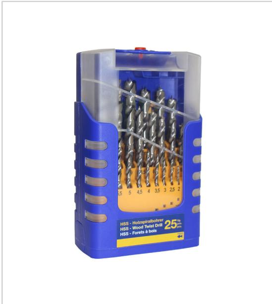
En acier HSSP ointe de centrage, 2 couteaux et 2 traçoirs Double listel pour une évacuation rapide des copeaux Queue cylindrique Pour le perçage dans les bois tendres, durs, laminés, recomposés, MDF, matériaux synthétiques et plexiglas. Vitesse de rotation : 1500-3000 t/min Queue cylindrique Composition : Ø 1-1,5-2-2,5-3-3,5-4-4,5-5-5,5-6-6,5-7-7,5-8-8,5-9-9,5-10-10,5-11-11,5-12-12,5-13 mm.
