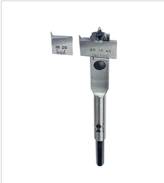
Mèche réglable, toutes les pièces sont en acier trempé, les 2 couteaux sont interchangeables pour un perçage facile, rapide et précis, à cote constante dans des bois tendres.
