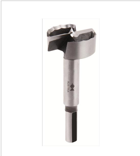
Applications: bois tendre ou dur pour le perçage de trous précis à cote constante, de demi-lune ainsi que trous en biais coupe ondulée brevetée "Wave Cutter" évitant l'échauffement pointe de centrage 2 traçoirs, 2 coupes dégageuses queue 3 pans décollée de longueur 30 mm.
