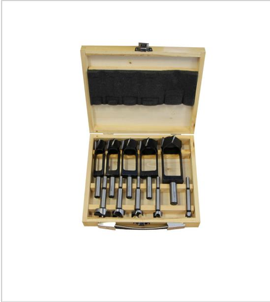
Coffret de 10 outils comprenant : 5 mèches à bouchonner Ø 15-20-25-30-35 mm Queue Ø 13 5 mèches à façonner Ø 15-20-25-30-35 mm Queue Ø 8 à utiliser sur une perceuse fixe (à colonne) application : en combinaison avec la mèche à façonner, la mèche à bouchonner permet d'éliminer les imperfections du bois (n'9cuds) et de réaliser des caches (clous, vis...).
