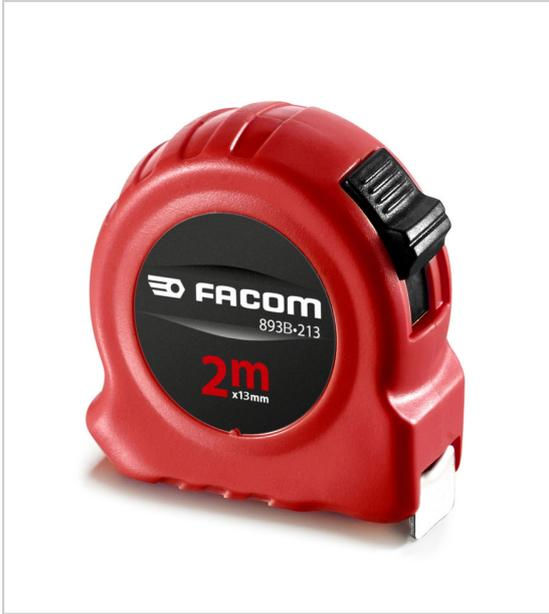
Boîtier ergonomique, matière ABS ruban avec revêtement nylon, mat antireflet grande rigidité du ruban crochet couvrant haute résistance : - 2 rivets avec plaque de renfort inox sur les 2 et 3 m - 3 rivets avec plaque de renfort inox sur les 5 et 8 m ruban imprimé double face, pour utilisation en réglet Poids : 96 g.
