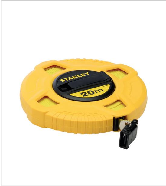
Ruban en fibre de verre renforcé (40 brins au lieu de 26) pour une élasticité réduite et une plus grande précision ruban jaune fluo pour une visibilité plus grande ruban avec revêtement PVC, insensible à la corrosion, traité anti-UV et non conducteur d'électricité graduation tous les 2 mm boîtier ABS antichoc boîtier ouvert pour un entretien à l'eau facile et rapide.
