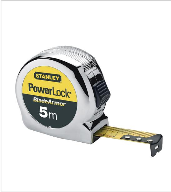
Revêtement Blade Armor thermoplastique pour une protection optimale du ruban sur les 8 premiers centimètres revêtement Mylar haute protection et anti-abrasion sur la totalité du ruban crochet 3 rivets offrant une bonne résistance à l'arrachement crochet avec position du zéro réel boîtier en ABS chromé antichoc, compact et ergonomique bouton de blocage du ruban agrafe pour port à la ceinture.
