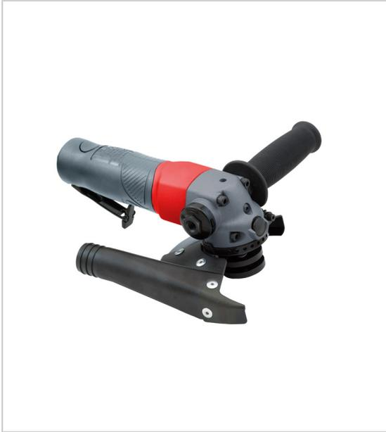
Ergonomie parfaite grâce à sa tête inclinée à 100°, son corps isolé, sa poignée auxiliaire anti-vibratile adaptée aux droitiers comme aux gauchers palettes KEVLAR carter pivotant sur 110° par simple pression sur une gâchette blocage des meules et des disques par écrou et vis centrale protection du blocage de l'arbre point de graissage du renvoi d'angle facilement accessible équipée d'une broche M14 x 2 mâle permettant de monter les accessoires des meuleuses électriques.
