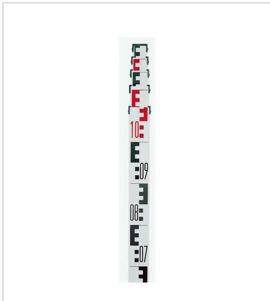
Mire télescopique composée de 4 éléments d'1 mètre blocage de chaque élément par bouton poussoir division topographique E droite et mm au dos graduation protégée par oxydation anodique.
