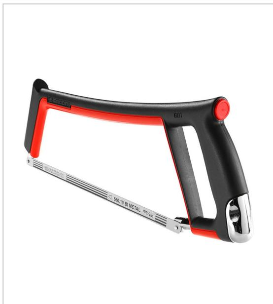
Monture de scie à métaux compacte structure métal-résine antichoc tension lame 80 Kg livrée avec 1 lame bi-métal 300 mm.
