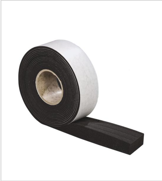
Joint d'étanchéité multifonctions de qualité supérieure en mousse de polyuréthane pré-comprimé et imprégné de résine acrylique avec une face adhésive, spécialement conçu pour les bâtiments à basse consommation énergétique.
