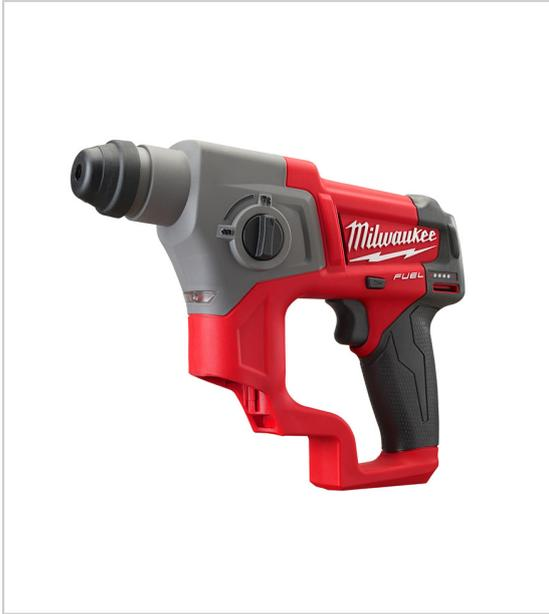
Moteur Brushless sans charbon protection contre les surcharges, les surchauffes et les décharges totales 2 fonctions : rotation + frappe pour le béton et rotation seule pour le bois et le béton vitesse de rotation : 900 tr/min sans batterie, ni chargeur.
