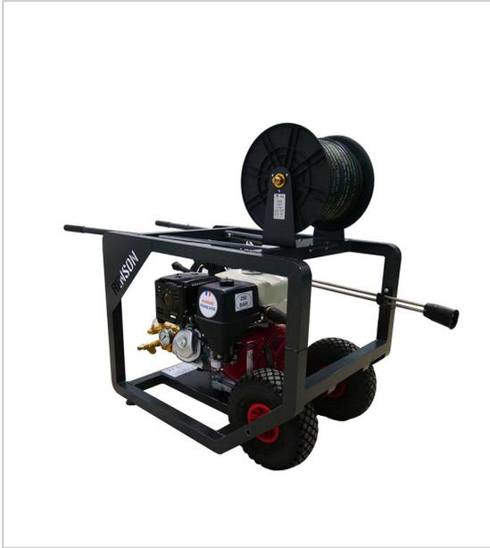
Nettoyeur autonome adapté aux usages intensifs des professionnels de la construction de bâtiment et des travaux publics Puissant : pression de 250 bar qui permet de décaper/désincruster Robuste, léger et durable : Son châssis en aluminium ultra léger est résistant à 1,5 tonne à l'arrachement Sécurité et manutention : équipé de 4 crochets de levage permettant de le déplacer rapidement et de le stocker en hauteur sur chantier.
