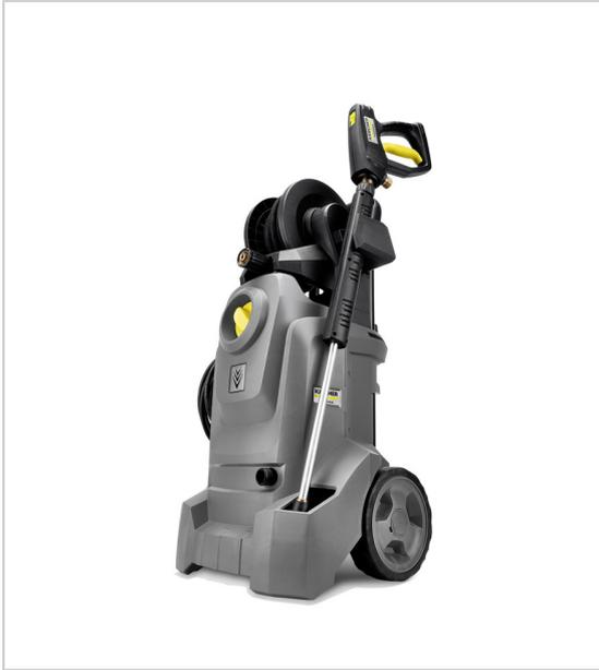
Pompe axiale à 3 pistons système automatique de décharge de pression pour la protection des composants sous haute pression poignée de pousse extensible enrouleur de tuyau livré avec poignée pistolet standard, lance 600 mm, tuyau caoutchouc HP 8m DN6, Power nozzle 25°, rotabuse.
