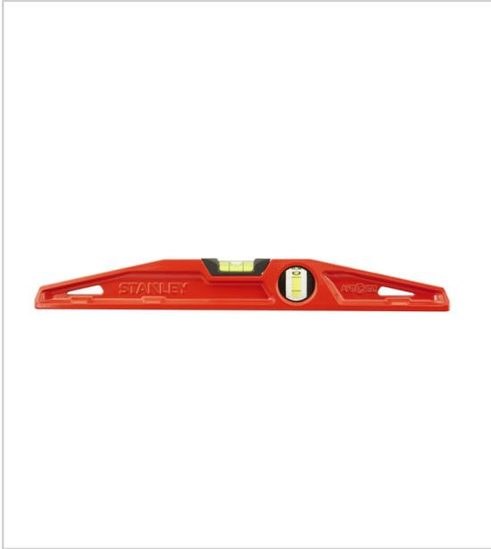
2 semelles usinées permettant de travailler avec précision corps massif en alliage d'aluminium léger et résistant fioles anti-chocs en Altuglass, incassables et réversibles fiole horizontale réglable peinture époxy résistante aux chocs et aux intempéries précision : +/- 1 mm/m.
