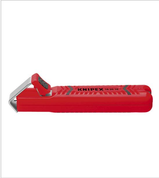
Pour dégainer tous les câbles ronds standard profondeur de coupe réglable grâce à la vis de réglage lame auto-pivotante pour coupe circulaire et longitudinale boitier en plastique résistant aux chocs ressort d'ouverture capacité : Ø 8 - 28mm.
