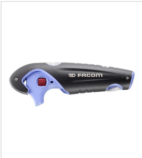
Système gâchette : 30% d'effort en moins lame auto-pivotante : rapidité et simplicité de dégainage. double sécurité : - Lame de coupe sortie = gâchette bloquée - Lame à cran d'arrêt capacité : câble rond PVC diamètre 4 à 28 mm zone de dénudage 872272 : jeu de 6 lames de rechange (5 lames auto-pivotantes et 1 lame de couteau).
