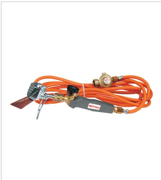
Comprend : - 1 lance avec panne compacte, flamme enveloppante type Cercoflam, puissance 1300W (ref 4678) - 1 manche à robinet à raccord tournant entrée 3/8e gauche, double étanchéité du raccordement aux lances, filetage raccordement lance M18 X 1 mâle (ref. 602) - 1 tuyau caoutchouc de 4,75 m avec raccords sortie 3/8e gauche femelle / Ø int. : 6,3 mm (réf. 963 / 5) - 1 détendeur propane 2 bars sortie 3/8e gauche / entrée écrou de bouteille à ailettes 21,8 x 1,814 à gauche (réf. 682)
