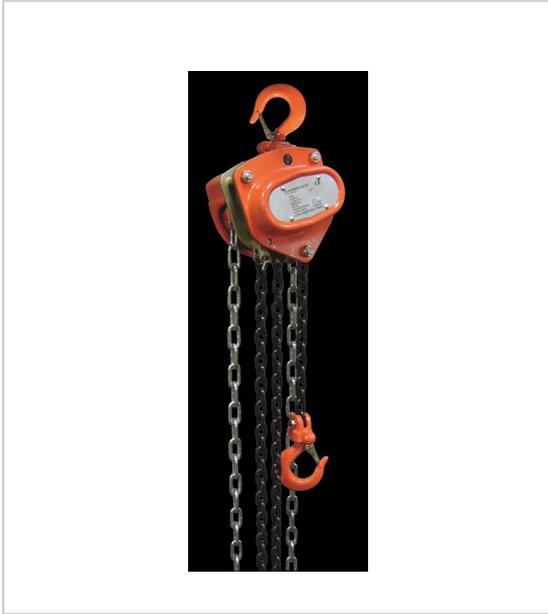
Crochets en acier forgé linguets de sécurité forgé chaîne de charge acier grade 80 coefficient 4 traitement anti-corrosion.
