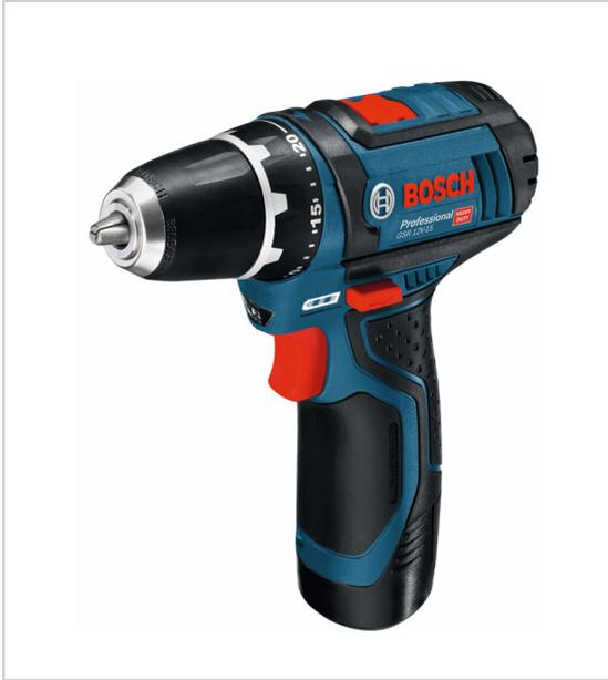
Engrenage 2 vitesses mandrin Auto-Lock 10 mm protection de la batterie contre la surcharge, la surchauffe et la décharge totale éclairage LED intégré réglage du couple sur 20 positions + 1 position de perçage régime à vide : 0-400/0-1300 tr/min Ø des vis maxi : 7 mm livrée en holster avec 2 batteries Li-Ion 12V 2Ah, chargeur GAL 12V-20.
