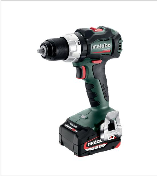
Moteur Brushless sans charbon Lampe intégrée pour éclairer la zone de travail Crochet de ceinture et chargeur d'embouts se fixant à droite ou à gauche Vitesse à vide : 0-600/0-2100 tr/min Livrée en coffret metaBOX avec 2 batteries Li-Ion 18V 5,2Ah, chargeur ASC55 "AIR COOLED", mandrins à serrage rapide, crochet de ceinture et chargeur d'embouts.
