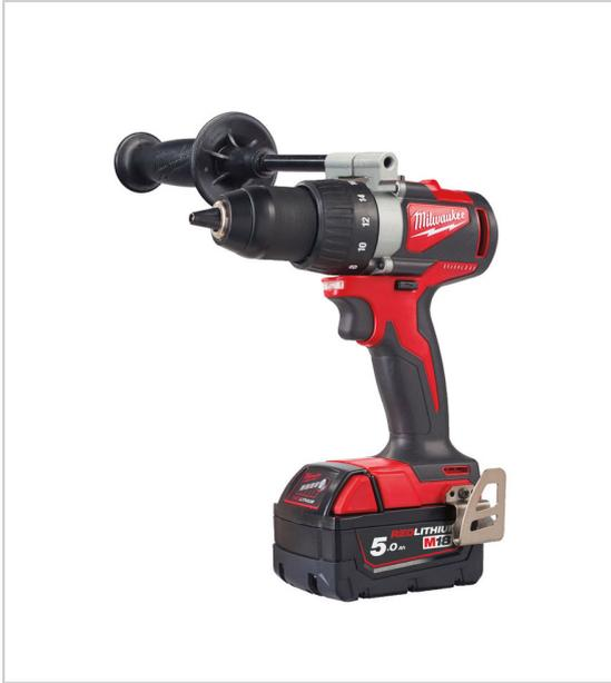
Moteur Brushless sans charbon mandrin métal 13 mm électronique REDLINK protégeant la batterie et l'outil contre les surcharges et les surchauffes pour une meilleure durée de vie de l'ensemble indicateur de charge et éclairage LED vitesse à vide : 0-550/0-1800 tr/min clip de ceinture réversible en métal livrée en coffret HD Box avec 2 batteries Li-Ion 18V 5Ah, chargeur.
