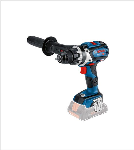
Moteur Brushless sans charbon mandrin métallique 13 mm débrayage de précision Kick back Control, arrêt automatique de l'outil en cas de blocage éclairage LED intégré vitesse à vide : 0-480/0-2100 tr/min livrée en coffret L-BOXX avec poignée supplémentaire sans batterie, ni chargeur.
