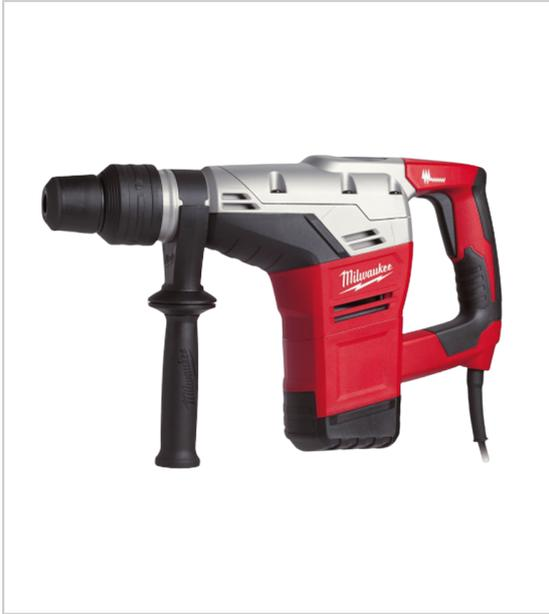
Démarrage progressif débrayage de sécurité fonction Variolock (12 positions) permettant de sélectionner l'angle d'attaque le plus adapté poignée Soft Grip système anti-vibration AVS vitesse à vide : 450 tr/min câble de 4 m livré en coffret avec poignée latérale, graisse.
