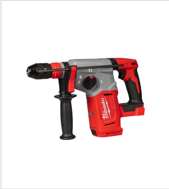
Moteur Brushless sans charbon boîte de vitesse entièrement métallique système FIXTEC permettant d'intervenir entre l'emmanchement SDS-PLUS et le mandrin auto-serrant 13 mm 4 modes pour plus de polyvalences : perçage-burinage, burinage, perçage, Variolock pour facilement orienter le burin vitesse de rotation : 1400 tr/min livré en coffret HD Box avec poignée latérale anti-vibration, butée de profondeur, graisse, mandrin métallique FIXTEC 13 mm sans batterie, ni chargeur.
