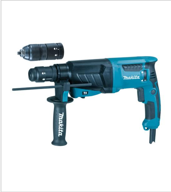
Mandrins interchangeables à verrouillage rapide (SDS-Plus et autoserrant) variateur de vitesse limiteur de couple protégeant le moteur ainsi que l'utilisateur en cas de blocage bouton de blocage pour un travail en continu inverseur de sens de rotation vitesse à vide max : 1200 tr/min câble de 4 m livré en coffret avec mandrin automatique interchangeable 13 mm, graisse pour emmanchement 100 ml, guide de profondeur.
