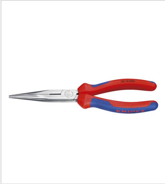
Pointes élastiques : indéformables, même soumises à la torsion pointes de précision flexibles et supportant la torsion mâchoires demi-rondes, longues et effilées avec tranchants pour fils doux, mi-durs et durs tranchants trempés par induction, dureté d'env. 61 HRC acier électrique au vanadium, forgé, trempé à l'huile en plusieurs phases
