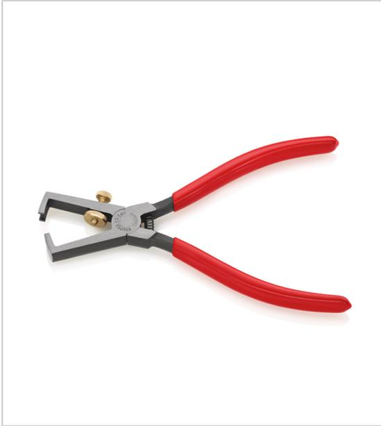
Pour conducteurs unifilaires, multifilaires et fils fins, isolation plastique ou caoutchouc jusqu'à Ø 5,0 mm et 10 mm<sup>2</sup> réglage simple du diamètre du câble ou du fil grâce à l'écrou moleté et au contre-écrou acier à outils spécial, forgé, trempé à l'huile pince noire atramentisée tête polie poignées gainées en plastique.
