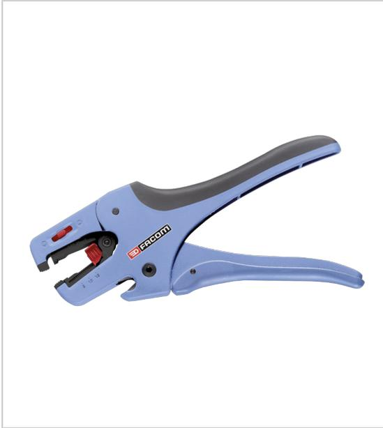
2 fonctions réunies : coupe et dénudage mécanisme à rattrapage de jeu, étudié pour un dénudage sans à coup et sans effort capacité de dénudage : 0,02 à 10 mm<sup>2</sup> (AWG : 32 - 8) réglage de la longueur de dénudage de 3 à 18 mm fonction coupe intégrée : - Coupe jusqu'à : 1,5 mm<sup>2</sup> fil monobrin - Coupe jusqu'à : 10 mm<sup>2</sup> fil multibrin corps ergonomique en nylon chargé de verre. 793207 : Mâchoire de rechange. 793910 : Jeu de 2 tampons de rechange.
