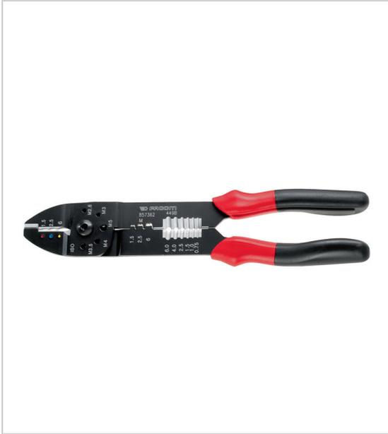
Mors rectifiés pour une plus grande précision de dénudage ou de sertissage gaine bi-matière épaisseur de la tôle : 4 mm fonction coupe-fil intégré sertissage pour cosses nues ou pré-isolés 1,5 - 2,5 - 6 mm<sup>2</sup> dénudage de conducteurs électriques 0,75 à 6 mm<sup>2</sup> coupe de fils de cuivre jusqu'à 6 mm de diamètre.
