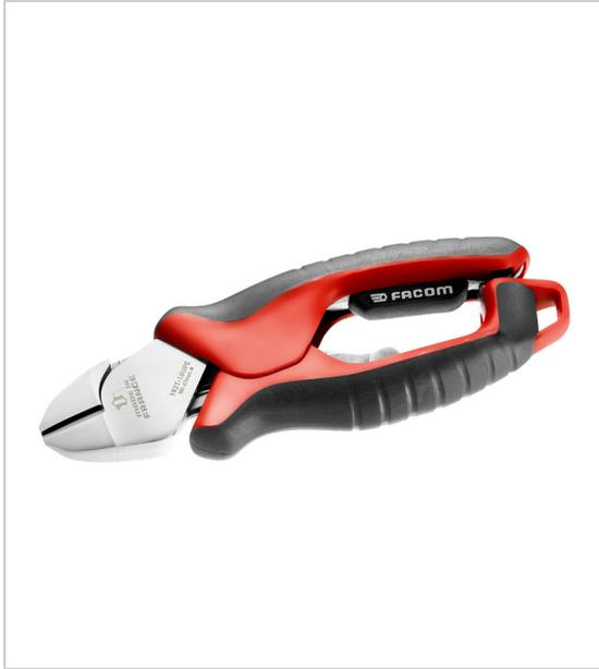
Poignée bi-matière ouverture inversée coupe 3 mm de corde de piano. partie supérieure moulée avec protège doigts système de ressort intégré profil de lame breveté et cinématique optimisée (force démultipliée et ouverture compacte) boucle d'attache intégrée, pour une compatibilité avec la gamme Facom SLS ou un autre système.
