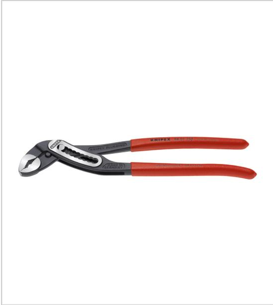
Branches gainées en PVC antidérapant charnière entrepassée autobloquante sur tubes et écrous dureté des dents environ 61 HRC acier électrique au chrome vanadium, forgé, trempé à l'huile 9 positions de réglage.
