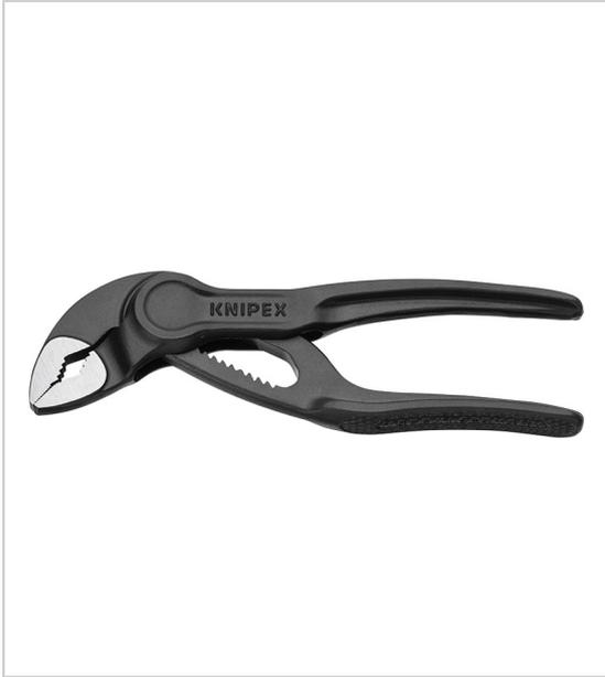
Accès optimal dans les espaces exigus : un design compact avec une tête très fine manipulation aisée à une seule main réglage fin d'une main par coulissement capacité de préhension de Ø 28 mm, et jusqu'à 24 mm sur du plat / écrou, charnière à double guidage mors de préhension avec dents spécialement trempées, dureté env. 60 HRC autobloquante sur tubes et écrous ergot de protection évitant les pincements réglage fin avec 11 positions.
