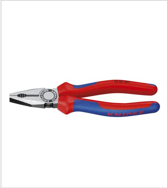
Pince atramentisée noire, tête polie poignées gainées bi-matière capacité de coupe du câble en cuivre, multifilaire : 16 mm<sup>2</sup> zone de préhension spéciale pour matériaux plats et ronds.
