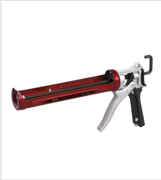
Pistolet destiné à un usage professionnel intensif poignée en aluminium injectée à forte démultiplication corps rotatif à 360° double transmission système "stop goutte" : pression relâchée sur le fond de la cartouche pointe pour déboucher les buses.
