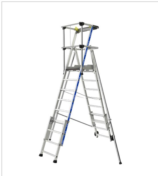
Fonction télescopique permettant 3 hauteurs de travail faible épaisseur de la PLATE-FORME repliée : 38 cm utilisable sur sol et en rattrapage de niveau (escaliers...) adaptation individuelle des stabilisateurs aux configurations des sols stabilisateurs repliables pour travailler dans les passages étroits plate-forme de travail anti-dérapante de 600 x 420 mm avec plinthe hauteur 100 mm garantie 5 ans.
