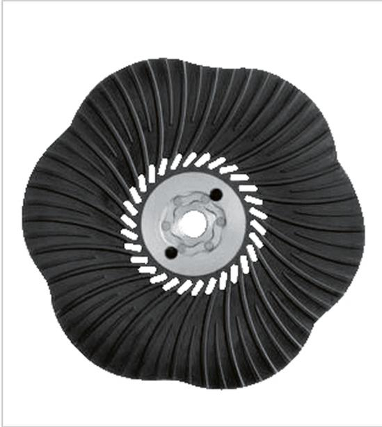
Adaptable à toutes meuleuses d'angle courantes géométrie des fentes d'aération assurant un débit d'air élevé réduisant les contraintes thermiques imposées au produit abrasif et à la pièce usinée système de serrage breveté réduisant au maximum la durée nécessaire au changement d'outils.
