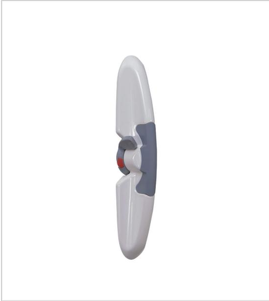
Poignée coquille CHRONOS intérieure à levier pour coulissant simple. Matière Zamak, finition laquée. Levier de verrouillage avec indicateur de position "Ouvert/Fermé". Fixation entraxe 43mm et carré de 7mm non fournis.
